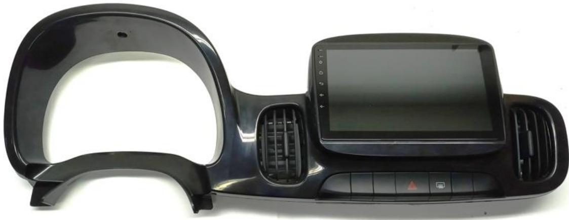
**3 – Faça as conexões elétricas e testes, encaixe no tabelier a moldura. Fixe o parafuso acima do velocímetro.**
