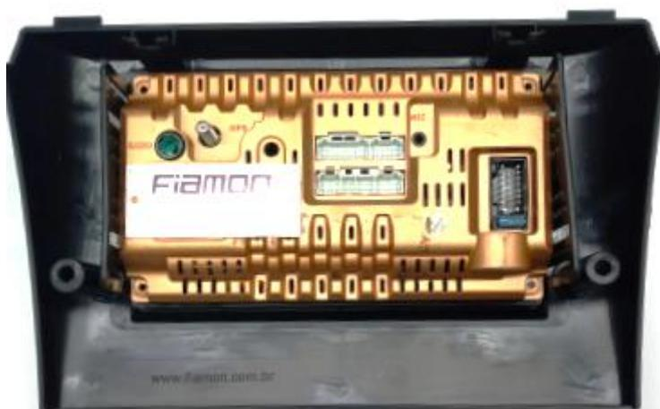
4 - Faça a conexões elétricas e testes. Para fixar a moldura no tabelier, primeiro encaixe parte superior, encaixando as travas no aeroduto. Fixe com os dois parafusos retirados da cinta metálica.
