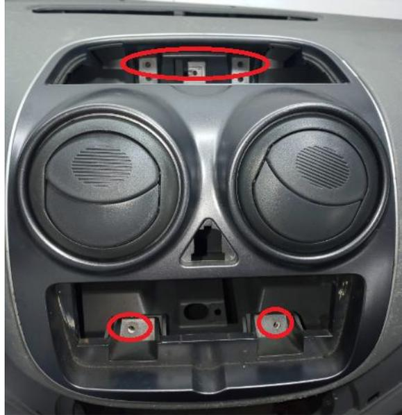
2 - Será necessário cortar os suportes do duto de ar, pois na nova instalação o duto interno ficará mais para cima.
