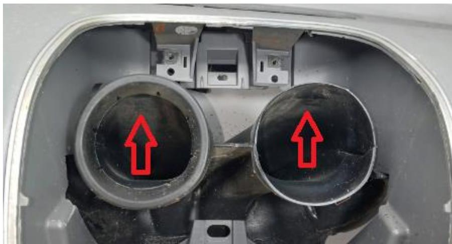
**3 - Instale pisca alerta, faça conexão, encaixe a moldura com o filete original, fixe a moldura com os parafusos originais.**
