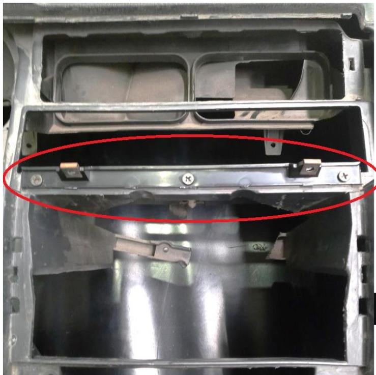
3 - Instale a capa e fixe com parafusos.
