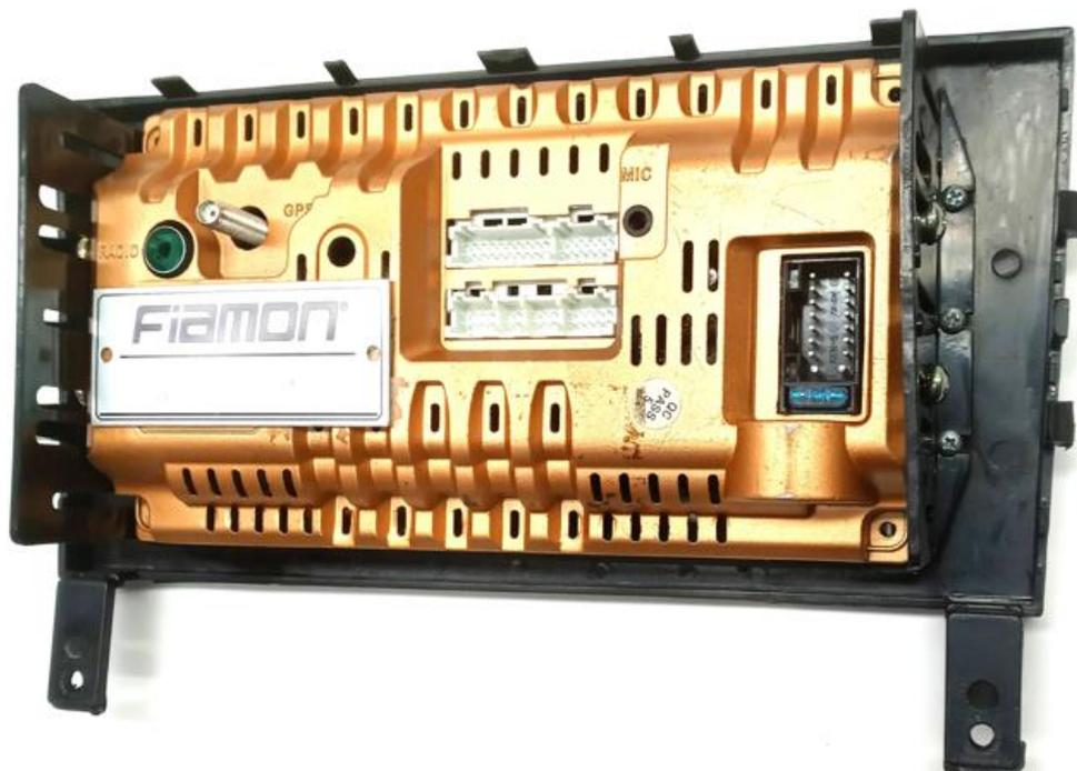
5 - Faça as conexões elétricas e testes da mídia, encaixe a moldura primeiro um lado posteriormente outro, as travas encaixam com pressão nos pontos 1, 2, 3 e 4. Coloque os parafusos inferiores na moldura. Instale demais componentes finaliza a instalação.
