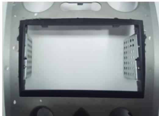
**3 - Encaixe o aparelho alinhando a frente da tela com a moldura, fixe o suporte ao chassi, caso necessite refaça o furo. Faça as conexões e reinstale no carro o conjunto.**
